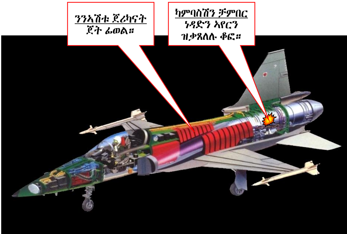
ፎቶ 7 ጀት ፊወል፡ ኣብ ብዙሓት ነንኢሽቱ ዝተፈላለዩ ጀሪካናት ኢዩ ዝቐመጥ።
